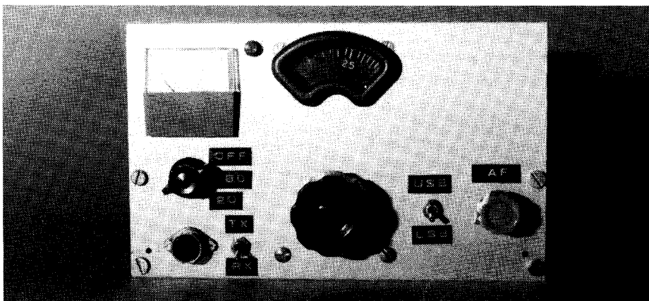
Vooraanzicht van de zendontvanger, de vertraging en de afstemschaal komen uit de surplus.
