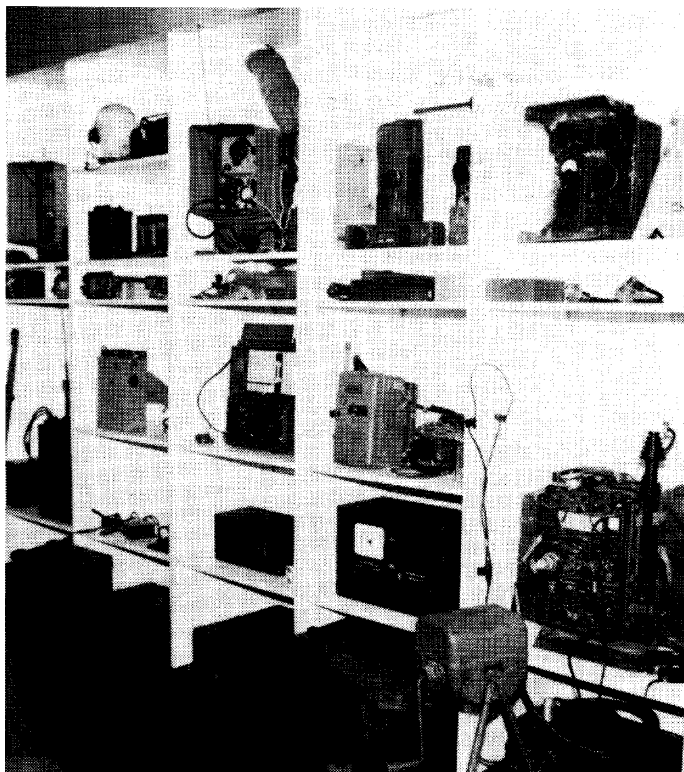
Draagbare radio-apparatuur. Te zien zijn o.a. WS-18, WS-38, WS-46, WS-48, BC-1000, BC-1306 (voorloper van de AN/GRC-9).
